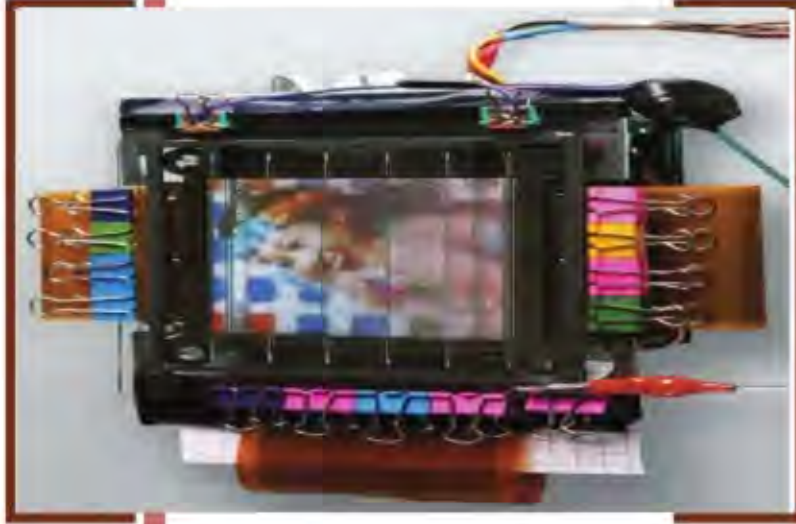
جهاز إشعاع المجال الذي يستخدم في تصنيع الشاشات المسطحة.
