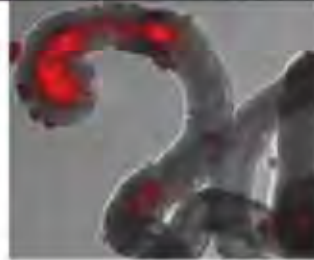
وضع خريطة لأنبوب كربون قطره ٨٠ نانومتر مع ذرات الحديد (١٠-٢٠ نانومتر)
